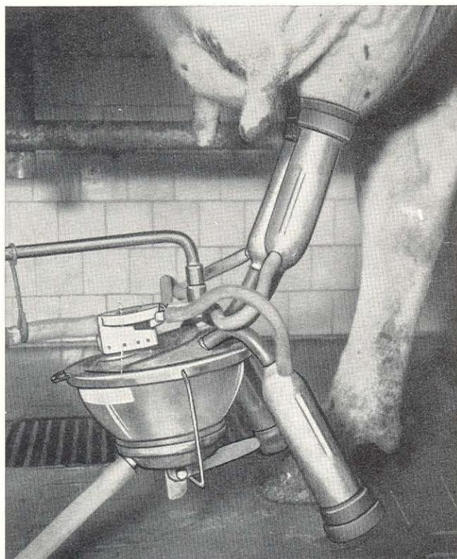
Il braccio di trazione acceleratore di mungitura e il sifone a camera di vuoto costante, sono nostri brevetti esclusivi ed equipaggiano tutte le nostre modernissime sale di mungitura.
