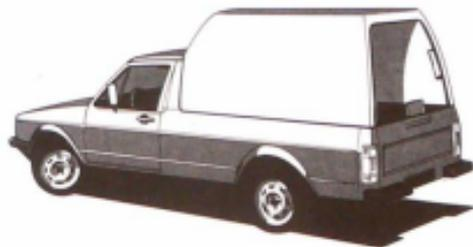
Nelle versioni Pick-Up e Furgone il Caddy è un veicolo da lavoro versatile ed economico, ma rimane una confortevole vettura. Ha una superficie di carico di 2,39mq, con una lunghezza di 1835mm, una larghezza di 1325mm, e un'altezza da terra del piano di carico di 640mm. La sua capacità di carico può arrivare a 905kg (versione Pick-Up). Ma ci sono tante altre cose da vedere e provare. Vi aspettiamo!
