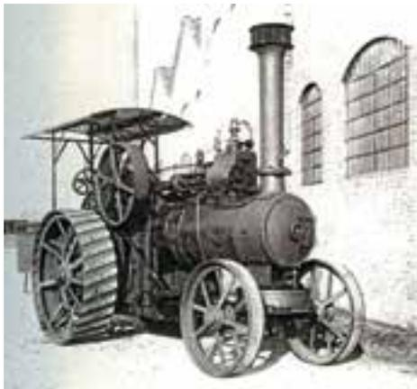
di secoli, mosso da una propria **autonoma forza motrice**. La macchina a vapore disponeva di tre pignoni di differente grandezza che potevano assicurare tre velocità. Le ruote posteriori avevano un diametro di cm. 152 e le anteriori di cm. 107. La stessa era in grado di trainare un peso di decine di quintali e poteva raggiungere la velocità di otto km. all'ora.
